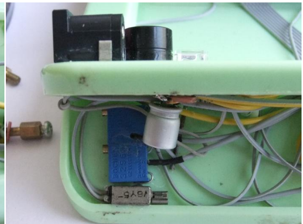
图 L 将震动电机接好并固定
