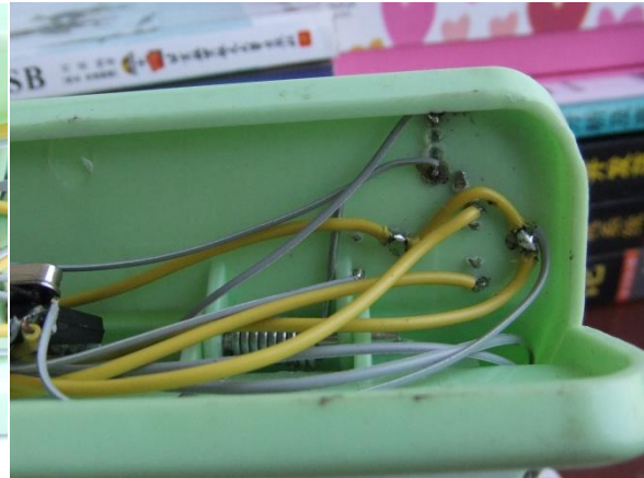
图 J 用导线连接好其他器件的引脚
