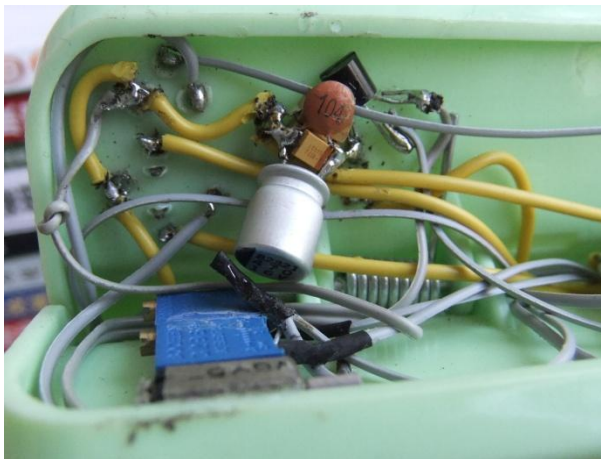
图 K 将滤波电容接到电源上
