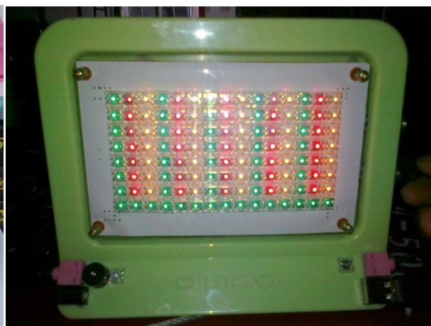
图 N 上电测试 LED 屏
