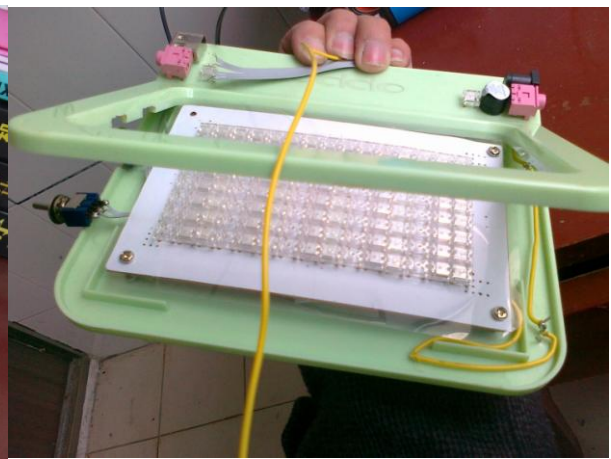
图 H 用铜柱将 LED 屏固定在外壳中
