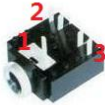
图五 音频插孔引脚，
